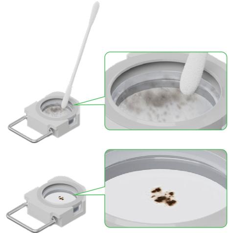
■ Si el protector de la lente está quemado o muy sucio e impregnado de impurezas, es necesario sustituirlo.
