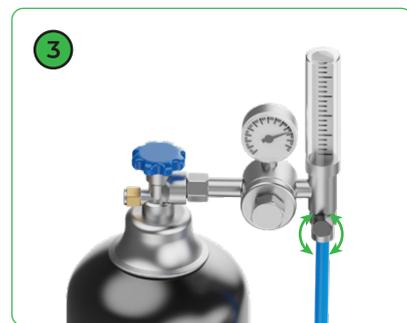
(3) Ajuste el caudal de gas a 15 L/min - 30 L/min
