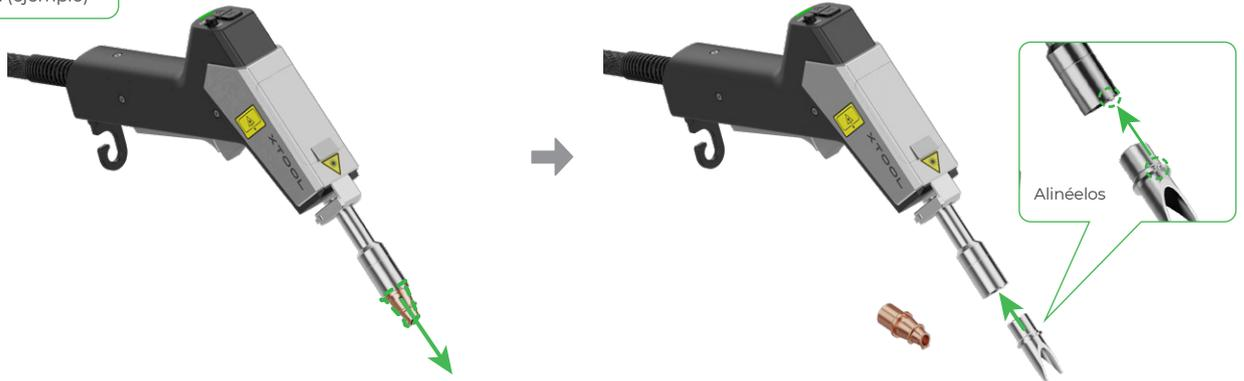
Sustituir la boquilla de alimentación de alambre
